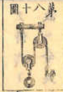
第八十圖 者夫ニ蓋シ二車ヲ用ルルト雖モ二 車ノ摩擦一車ノ摩擦ニ二倍スルヲ以
