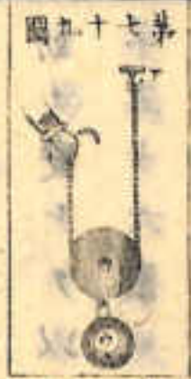
第七十九圖 一端ヲ(ア)ニ動カ州ル處ニ繫ケ他ノ 一端ヲ(イ)ノ處ニ牽揚スル者ナ
